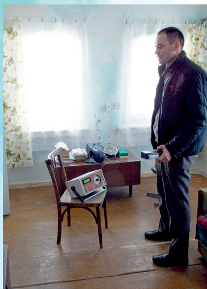
Измерение уровня радона в одном из частных домов
