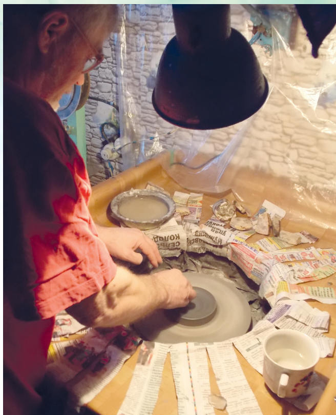
Полировка агатов на самодельном оборудовании
